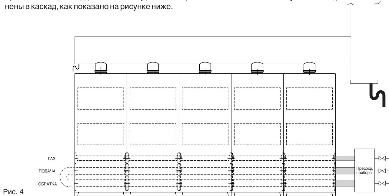
Котлы, соединенные подобным образом действуют как единый генератор "эквивалент", с общей мощностью  $N \times 90,4$  кВт. Необходимо, чтобы были удовлетворены все нормы как для котла с мощностью  $N \times 90,4$  кВт. В частности, место установки, предохранительные приборы и системы эвакуации дыма должны быть адекватны мощности  $N \times 90,4$  кВт.
