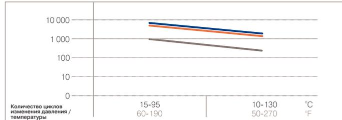
Различные типы пластинчатых теплообменников, изготовленных методом пайки твердым припоем, были подвергнуты испытаниям с целью сравнения их усталостной прочности при различных значениях давления и температуры.
