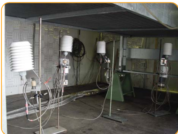
Измерение производительности сухих градирен DFC
