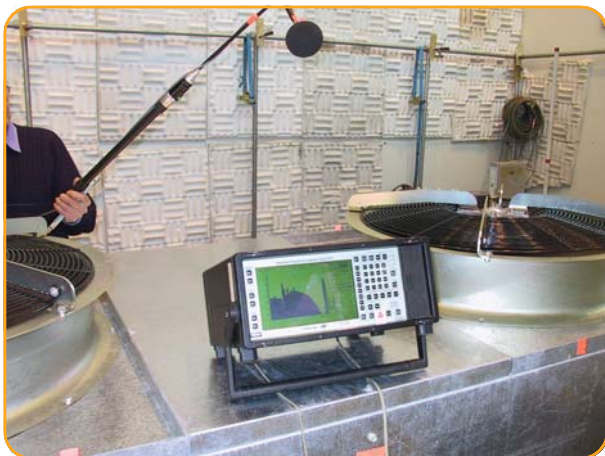
Акустическая проверка сухой градирни DFC
