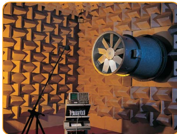
Акустическая проверка вентиляторов DFC
