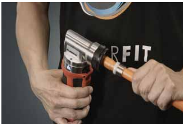
Нажмите кнопку, расширьте трубу до конца (до упора) поверните примерно на 15 - 30 градусов и повторно расширьте трубу до конца (до упора) (для фиксации памяти формы труб РЕХ).
