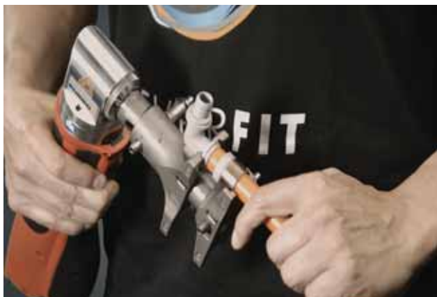
Оденьте монтажные головки пресс-инструмента на фитинг и кольцо, нажмите кнопку. Надвиньте натяжное кольцо до упора на фитинг. После монтажа головки должны вернуться в свое первоначальное положение
