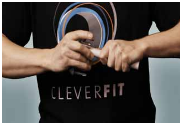
Калибровка с помощью калибратора соответствующего диаметра придает трубам округлую форму и выравнивает их внутренний край.
