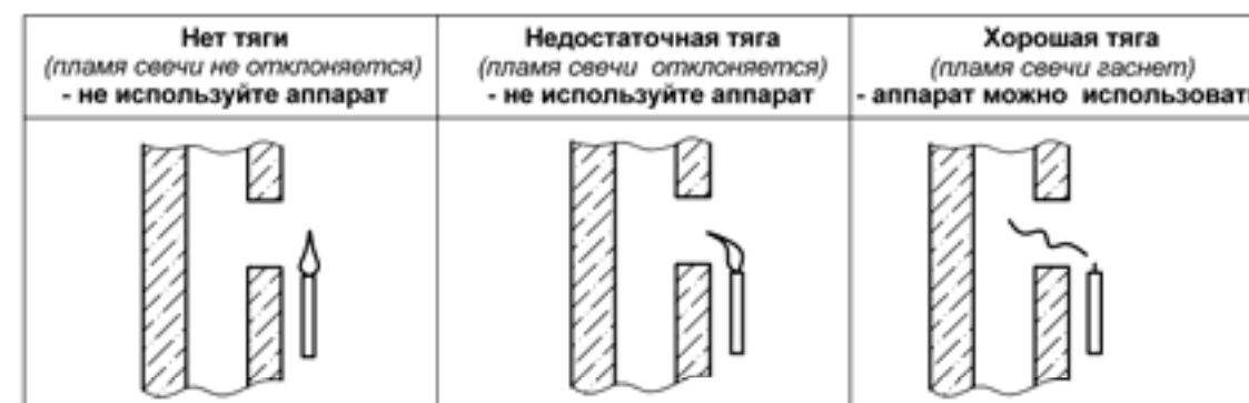
Рисунок 4. Способ проверки тяги в дымоходе
