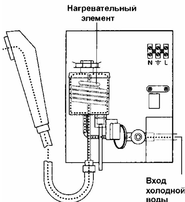
**Принцип работы электрического проточного водонагревателя**
