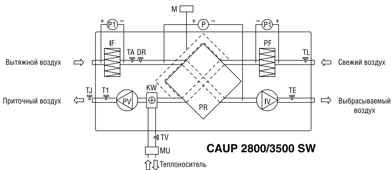
PV — вентилятор приточного воздуха.
