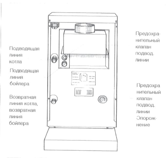
Рис. 3. Подключение воды
