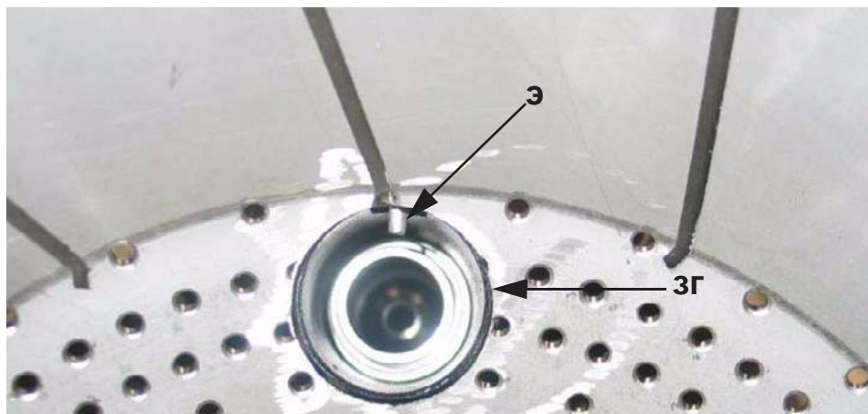
Рис. 29 - Часть диффузора с запальной горелкой (P) и запальным электродом (E).
