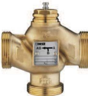
Клапан 4037 предназначен для плавного регулирования теплоносителя или воздуха в закрытых циркуляционных контурах систем отопления и холодоснабжения. С помощью электропривода клапан может принимать любое промежуточное положение. При поднятии штока клапан закрывается. Зацепление шпинделя с приводом происходит автоматически.
