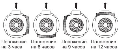
Рис. 8 Расположение клеммной коробки, вид сверху
