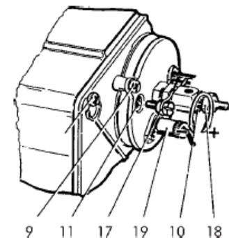
**РЕГУЛИРОВКА ДАВЛЕНИЯ НАГНЕТАНИЯ НАСОСА**
