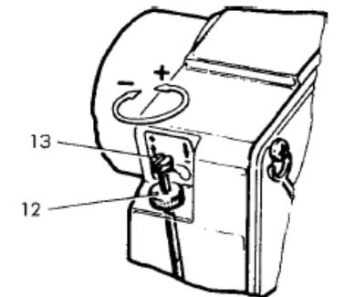
**РЕГУЛИРОВКА ДЕРЖАТЕЛЯ ФОРСУНКИ**
