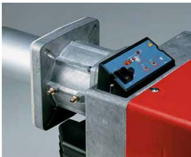
LO400 - Particolare del pannello sinottico e delle prese di pressione dell'aria in testa e della contropressione in camera di combustione - Часть мнемосхемы панели управления и штуцеры отбора давления воздуха на головке сгорания и аэродинамического сопротивления в камере сгорания
