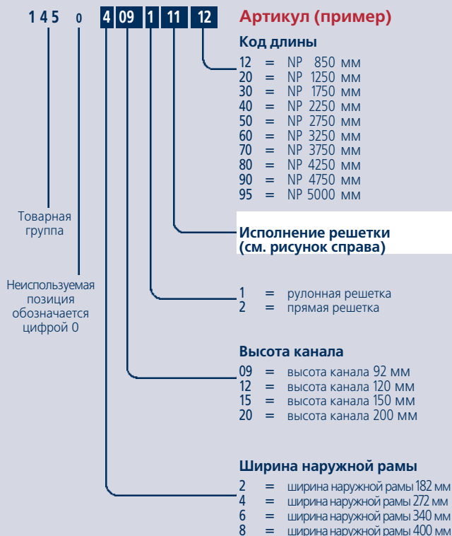
Пример: Katherm NK 272, высота конвектора 92 мм
