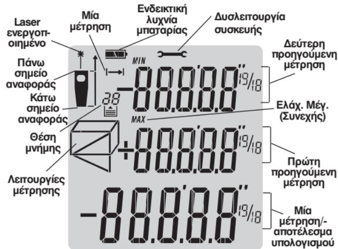
Εικόνα 3 – Η οθόνη LCD του micro LM-100
