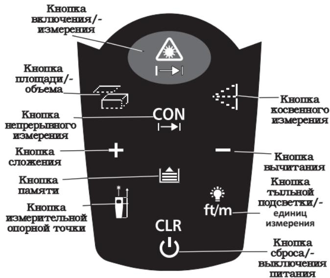
Рисунок 2 – Кнопки прибора micro LM-100
