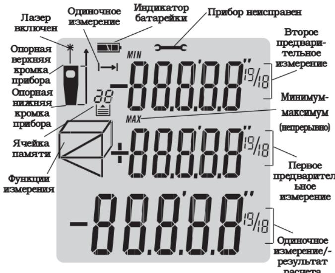
Рисунок 3 – ЖК дисплей прибора micro LM-100
