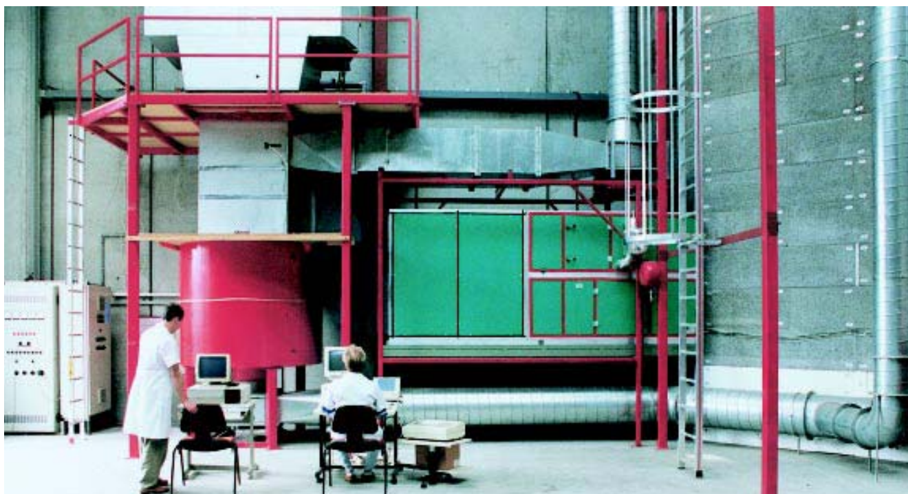
Рис. 9: Теплообменники Noval постоянно проходят стендовые испытания на достоверность технических данных
