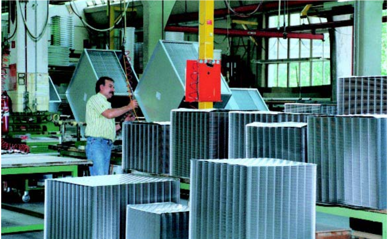
Рис. 20: Блок теплообменника плотно устанавливается внутрь корпуса
