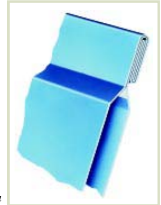
Рис. 16: Посредством двойной фальцовки достигается прочное соединение пластин
