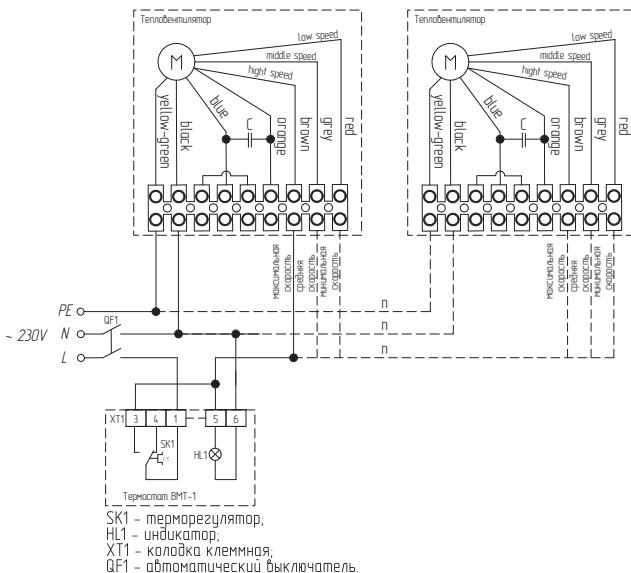
**Подключение водяного тепловентилятора к терmostату BMT-2, осуществление регулировки температуры воздуха, подачей теплоносителя.**
