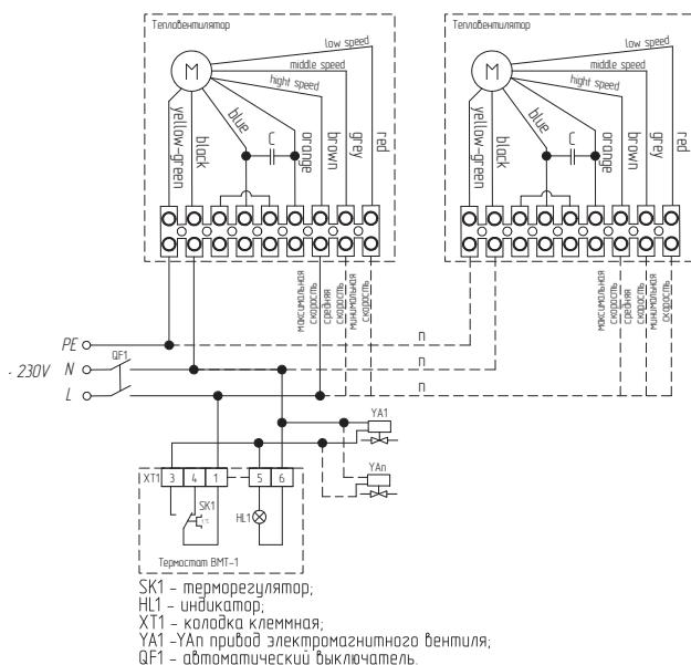
**Подключение водяного тепловентилятора
