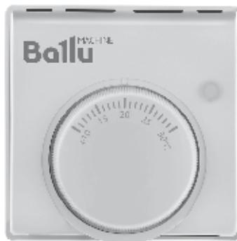
Термостат механический ВМТ-1 применяется для регулирования поддерживаемой в помещении температуры. В качестве чувствительного элемента используется сильфон, заполненный газом. Обычно применяется в коммерческих помещениях, в домашних системах отопления и кондиционирования воздуха совместно с климатической техникой. Данный термостат не устанавливается в помещениях с повышенной влажностью и в агрессивных средах (Класс защиты IP40).
