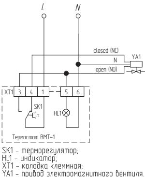
**Групповое подключение водяных тепловентиляторов к термостату BMT-1, осуществление регулировки температуры воздуха, подачей теплоносителя.**
