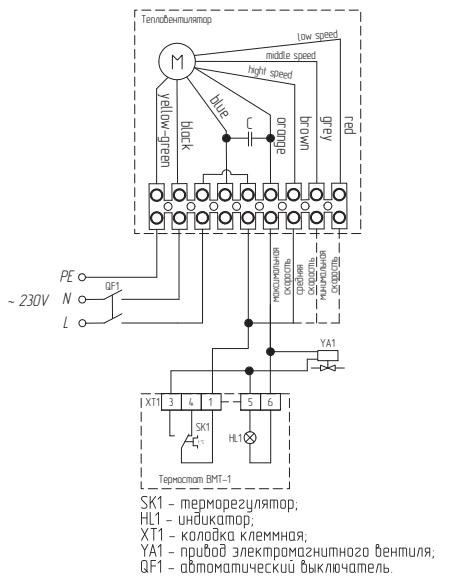
**Принципиальная схема подключения привода двух-/трехходового вентилятора без возвратной пружины к терморегулятору BMT-1.**
