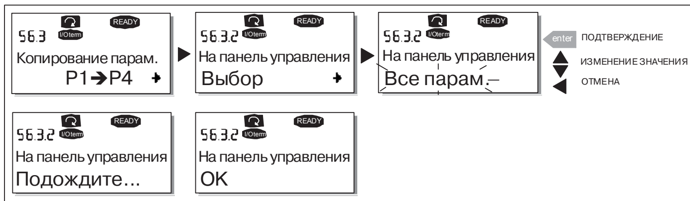
Рисунок 7-12. Копирование параметров в панель управления
