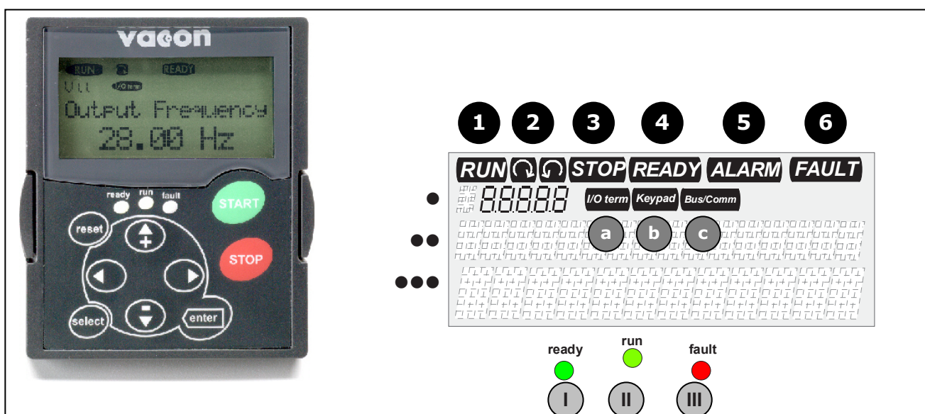
Рисунок 7-1. Панель управления преобразователя частоты Vacon NX и индикаторы состояния привода
