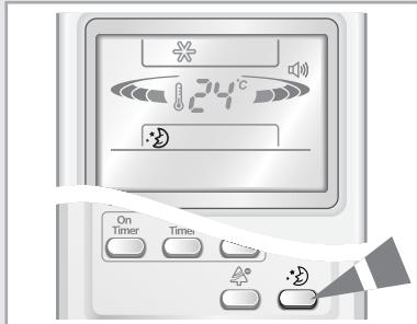
Вы можете установить Таймер Сон, чтобы автоматически выключить кондиционер во время сна. Кондиционер прекратит работу по окончании 6 часов со момента установки Таймер Сон.
