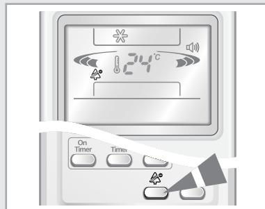
Кондиционер может производить анион с ионизатором на комнатном блоке. Так как это дополнительная функция, то вы можете выбрать ее в любом режиме, даже когда кондиционер выключен.
