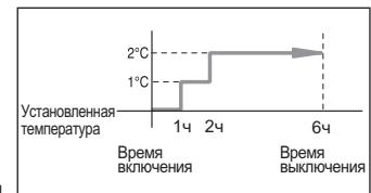
**Обогрев** Установленная температура увеличивается на 1°C каждый час. После повышения на 2°C, температура сохраняется в течении 4 часов.
