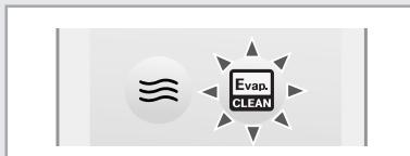
*Вы можете выбрать Функцию Авточистки, если вы хотите очистить кондиционер или удалить плесень. Даже при выключенном кондиционере, вы можете установить данную функцию.*
