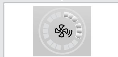
Вы можете выбрать режим Охлаждения, если вы хотите охладить вашу комнату. Вы можете отрегулировать температуру и скорость вентилятора при охлаждении.
