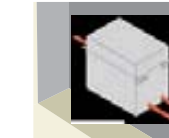
Установка блока управления сверху (в узком пространстве).
