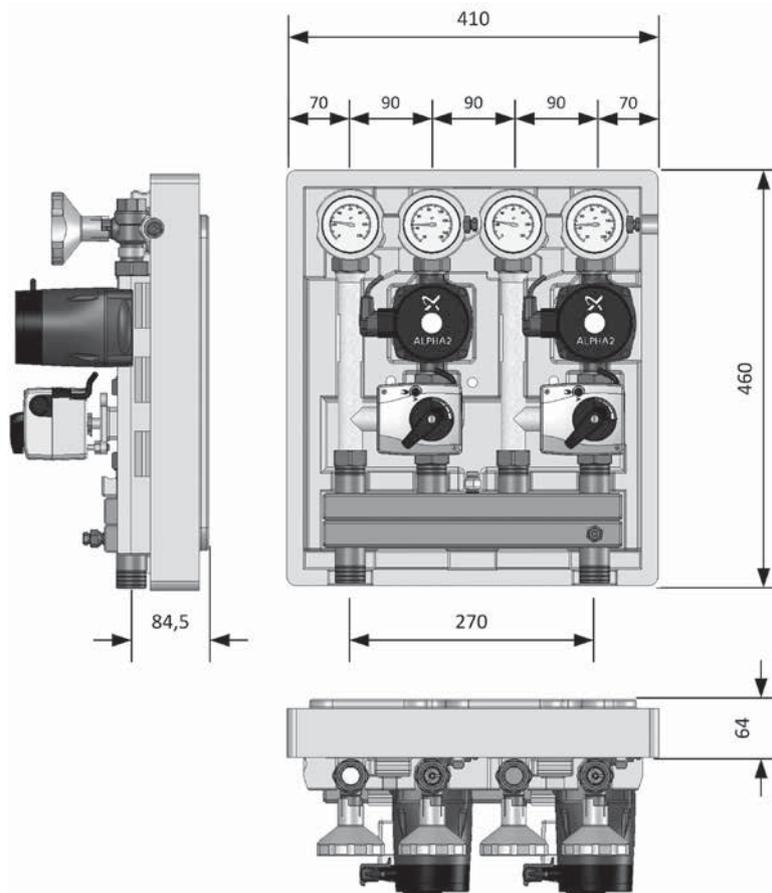
Внешние габаритные размеры теплоизоляции:
