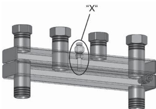
Монтаж для низкого перепада давления: демонтируйте клапан и снова его установите, повернув на 180°.
