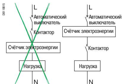
Пример: счётчик установлен между аппаратами коммутации нагрузки
