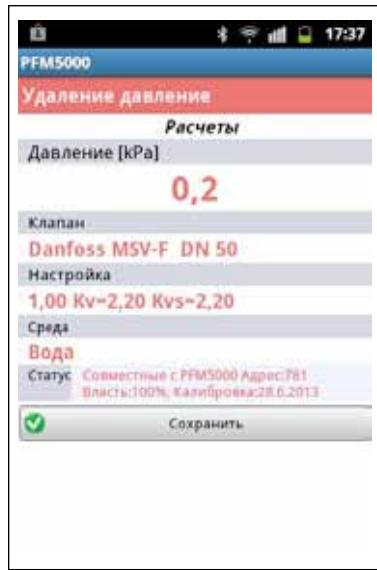
5. Закройте клапан и измерьте располагаемое давление в ветви.
