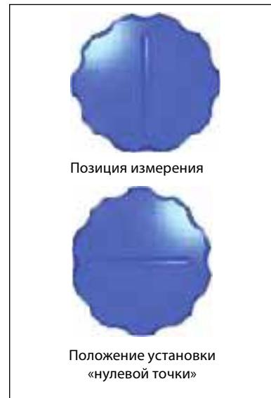
1. Для измерения незначительного перепада давления – менее 500 Па – ручку установки «нулевой точки» необходимо повернуть так, чтобы ось была в горизонтальном положении.
