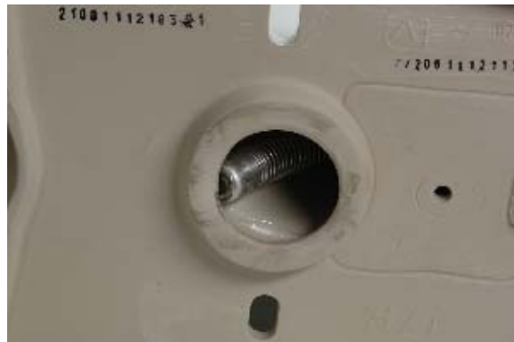
Рисунок 16 – Головка камеры застряла в изгибе
