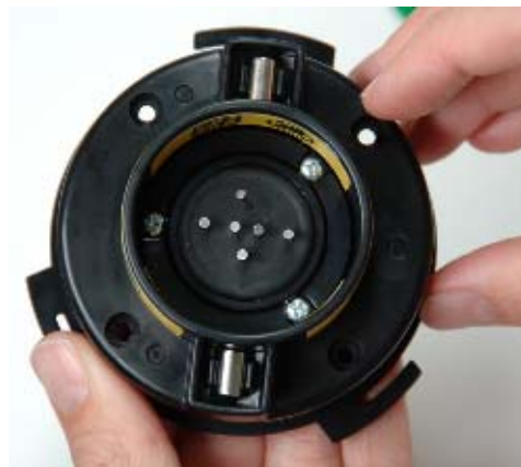
Рисунок 6 – Сломанный контактный штырь
