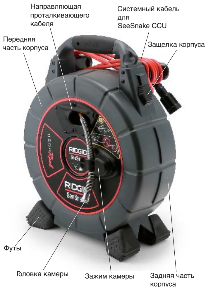
Рисунок 1 – Вид спереди (Схема SeeSnake)
