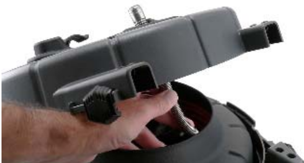
Рисунок 5 – Укладка головки камеры
