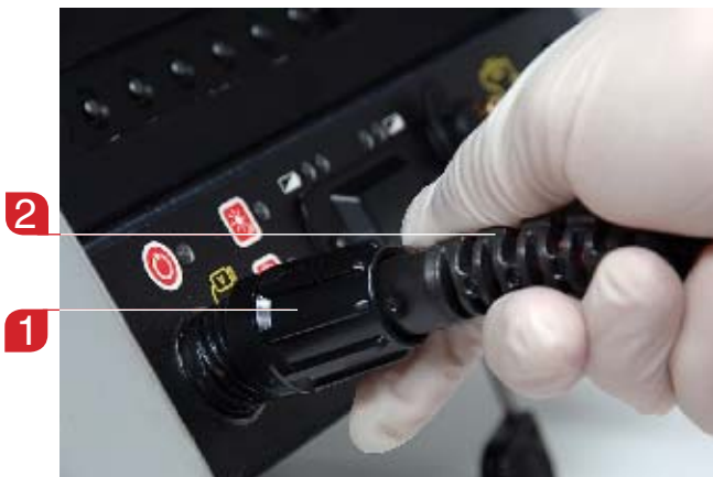
Рисунок 12 – Подключение к SeeSnake CCU
