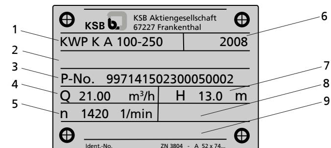
Рисунок 5: Заводская табличка KWP
