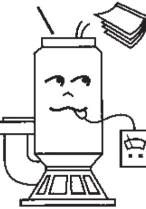
Contrôler régulièrement l'isolation, le pouvoir isolant de la pompe
