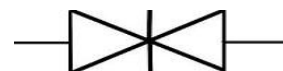
Вариант 3. Знак "Задвижка клиновидная или шиберная" Шаровой кран так обозначать неверно, но обозначают так часто.
