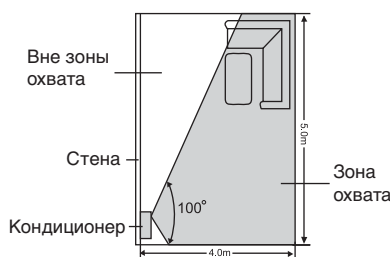
Кондиционер установлен в левой стороне комнаты
