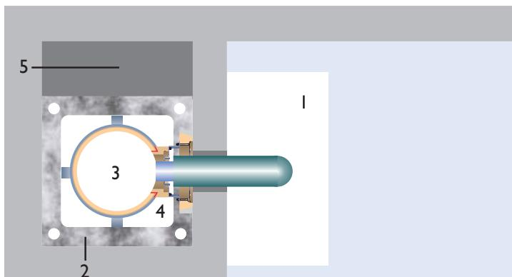
Крепление теплогенератора к кирпичной стене, окружающей дымоходную систему
