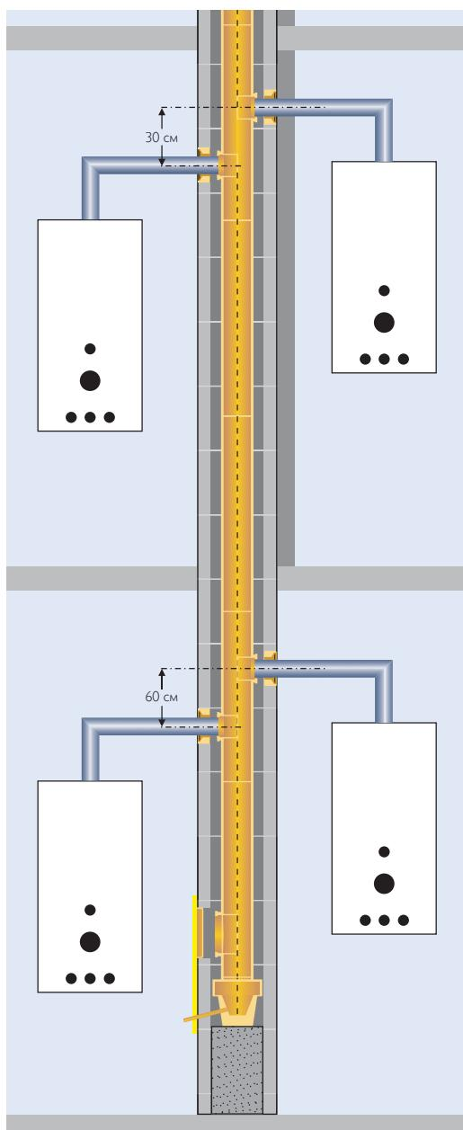
В соответствии с п. 6.2.5 СНиП 41-01-2003 к о. ном. коллективному дымоходу следует предусматривать не более одного теплогенератора на этаже»
