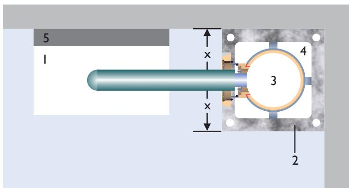
Подключающая труба расположена по оси системы Quadro
