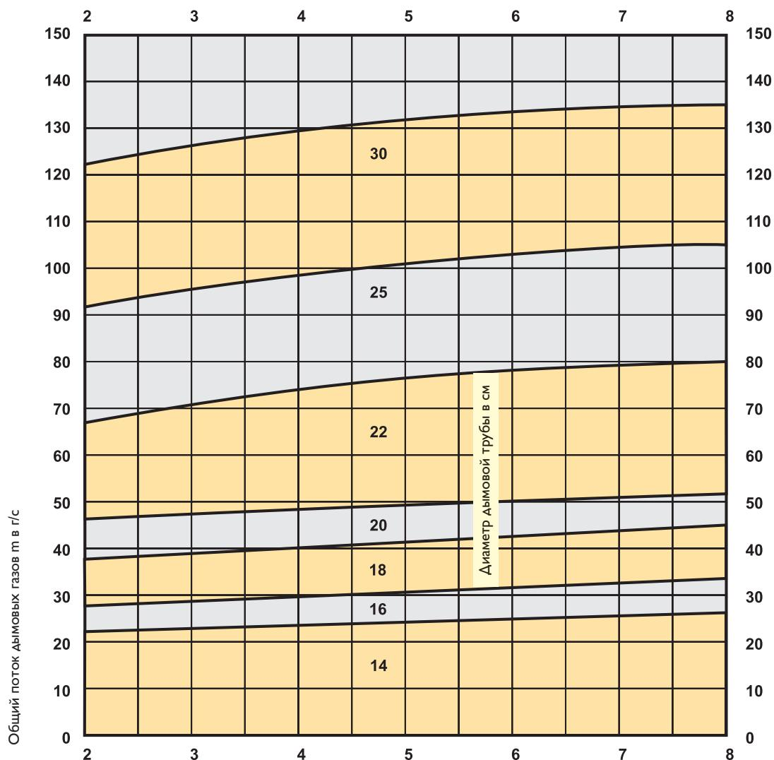
Высота дымовой трубы от точки подключения верхнего котла H, м
