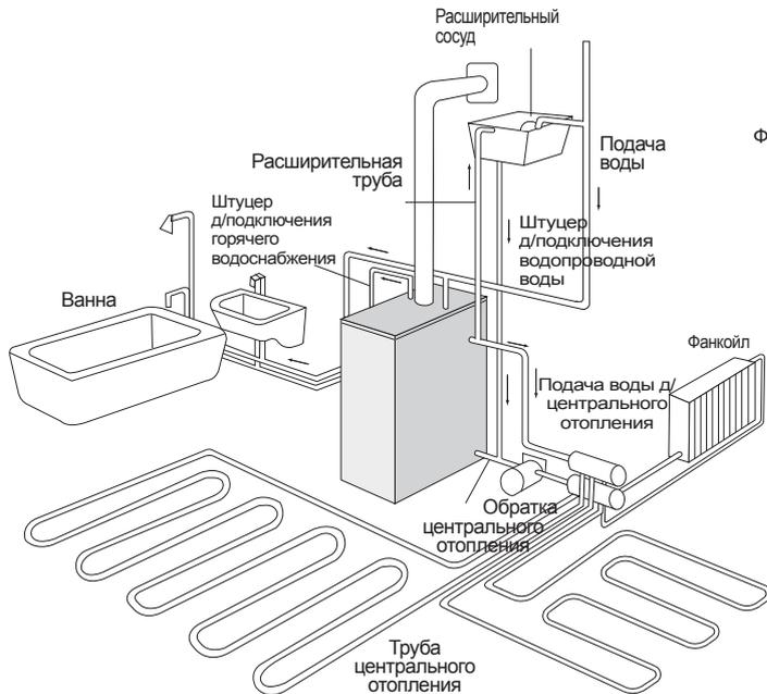
■ **Стандартная схема трубной обвязки (Открытый отопительный контур)**
