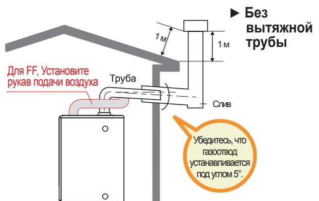
Труба должна устанавливаться на расстоянии не менее 1 м над уровнем крыши. И на оконечность трубы устанавливается отбойник для дождевой воды, что позволяет предупредить неполное сгорание топлива в результате задува ветра в трубу.
