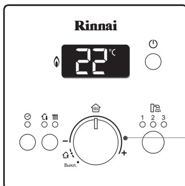
Регулятор температуры отопления.
