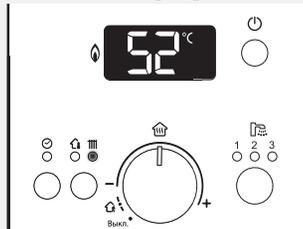
Установка температуры теплоносителя возможна регулировать на промежутке 40-85°C
