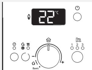
Установка температуры в помещении возможна регулировать на промежутке 5-40°C
