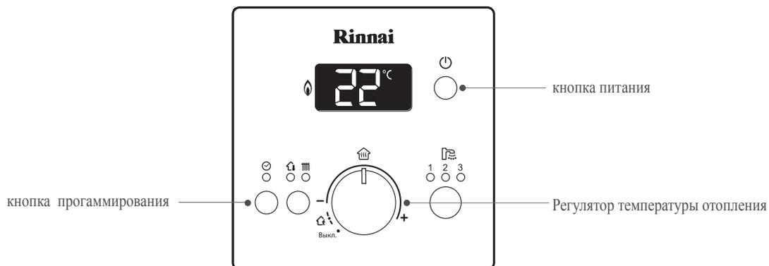
1 Нажмите кнопку питания . И установите желаемую температуру поворачивая регулятор температуры отопления.
