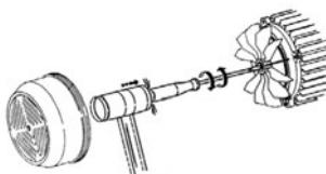
Zkontrolujte, zda směr otáčení motoru souhlasí s údajem uvedeným na výkonovém štítku (vrkulka ventilátoru se musí při pohledu ze zadu točit VE SMĚRU HODINOVÝCH RUČIČEK). Jestliže se jedná o třífázový motor a zjistíme, že se točí opačným směrem, je nutno mezi sebou vyměnit na jističi dva fázové přívodní vodiče.
