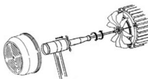
Compruebe que el sentido de giro del motor coincida con el indicado en la placa de características (el ventilador debe girar, mirando por la parte trasera del motor, en SENTIDO HORARIO). Si la bomba es trifásica y observamos que el sentido de giro es incorrecto se deben invertir dos fases de alimentación del cuadro de protección.
