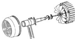
Prüfen, ob die Drehrichtung des Motors mit der Angabe auf dem Typenschild übereinstimmt (der Lüfter des Motors muß sich von hinten gesehen im UHRZEIGERSINN drehen). Bei einer Pumpe mit Dreiphasenmotor müssen bei falscher Drehrichtung zwei Phasen der Netzzuleitung am Schutzgerät vertauscht werden.
