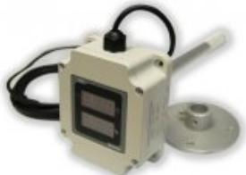
Цифровой датчик температуры и влажности с выходом Modbus RTU. Используется совместно с увлажнителями (секциями увлажнения) Breezart с нагревателями. Позволяет реализовать пропорциональное управление увлажнителем для точного поддержания уровня относительной влажности воздуха.
