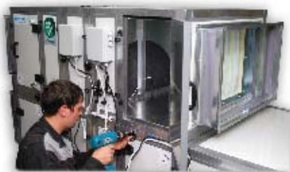
Для приточных установок выпускаются совместимые вытяжные модели, скорости вращения их вентиляторов синхронизированы (приточная установка управляет вытяжной).
