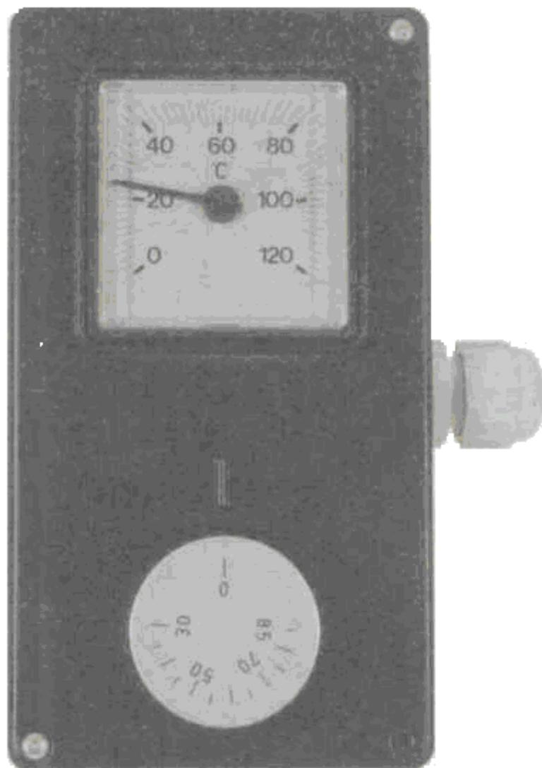
Для регулировки температуры воздействовать на ручку **4**, обеспечивая совпадение желаемого значения с указателем на корпусе блока. Замыкание и размыкание контакта происходит посредством определения температуры воды с помощью датчика терморегулятора помещённого в гильзу бойлера. Управление процессом нагрева воды в приборе осуществляется датчиком терморегулятора автоматически.
