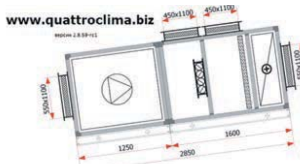
Рис. 5. Подбор вентагрегатов QC-CDTA-PL
