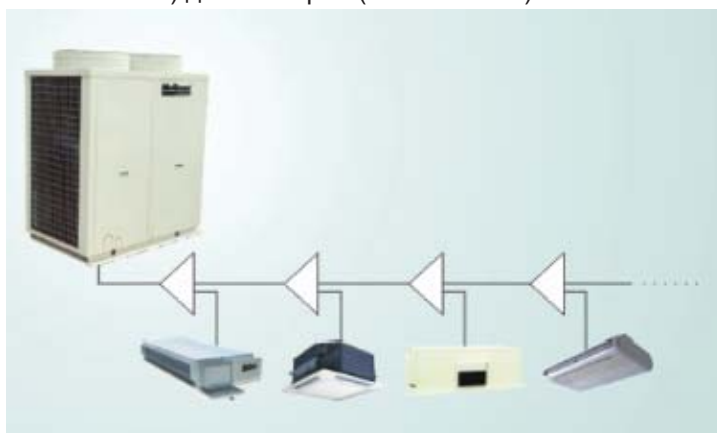
Общая схема гидравлического соединения блоков
