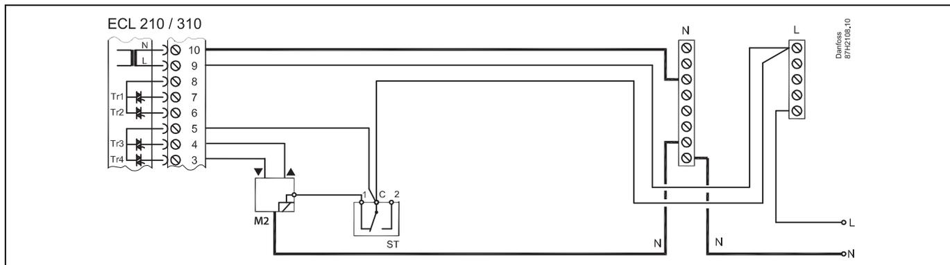
**С термостатом безопасности, двухступенчатое закрытие:**
