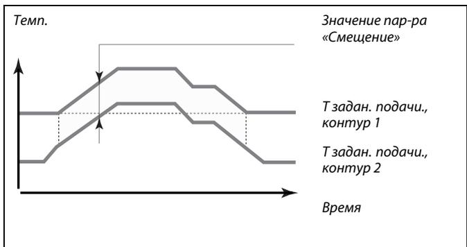
Функция «Смещение» позволяет компенсировать потерю тепла между основными и ведомыми системами.
