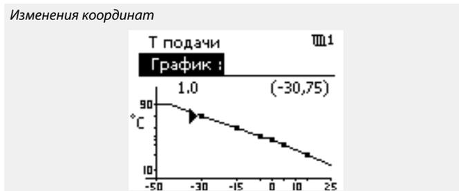
Расчетная температура подачи (котла) может изменяться функциями "Натоп", "Скорость" и т.п.
