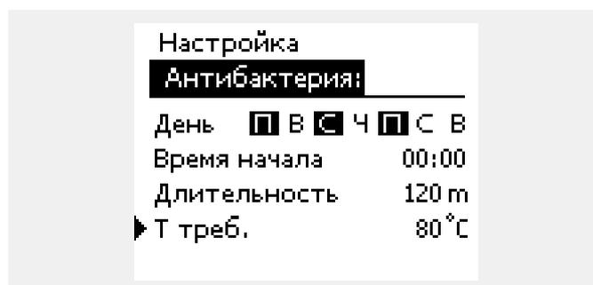
Во время работы антибактериальной функции ограничение температуры обратного теплоносителя отключено.
