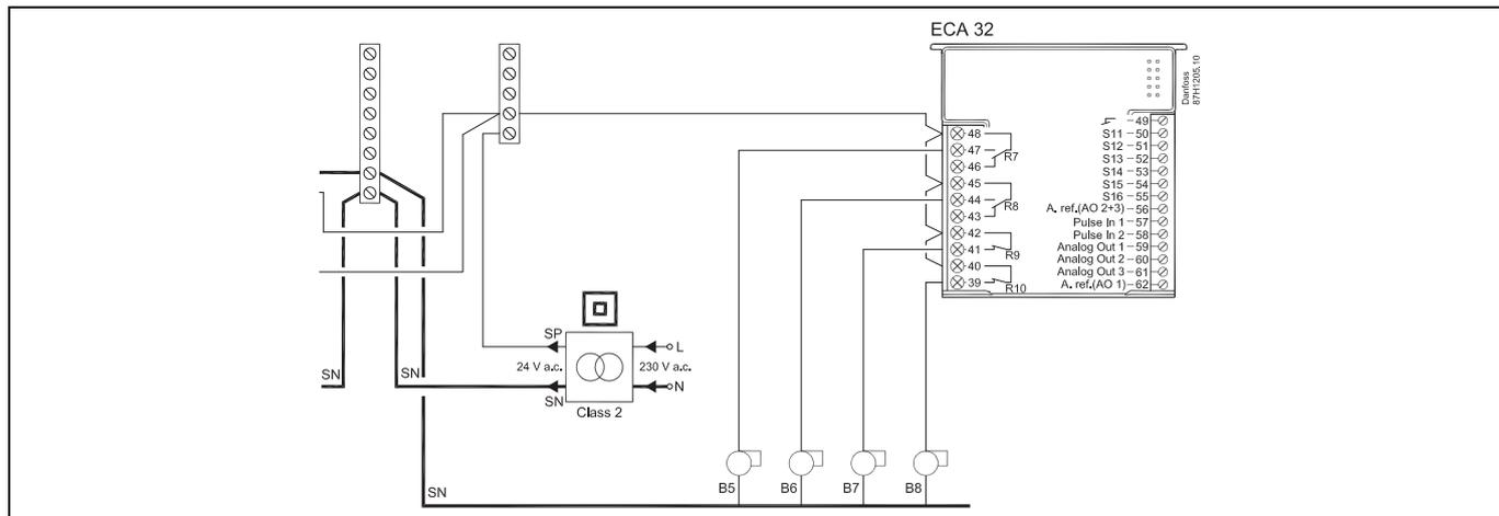
Трансформатор с двойной изоляцией (двухкамерный)
