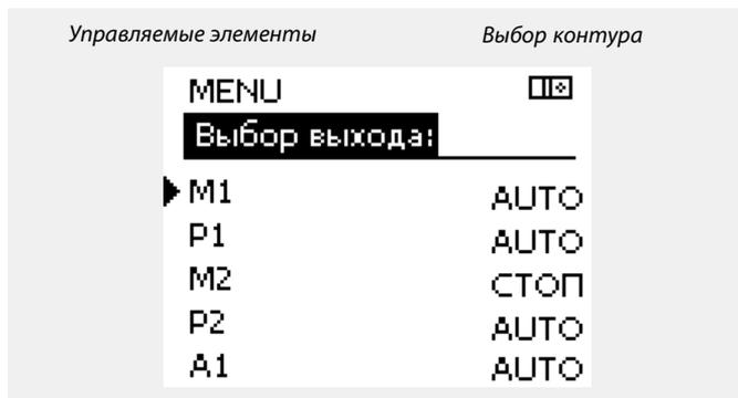
Если выбранный управляемый элемент (выход) не находится в состоянии "АВТО", то регулятор ECL Comfort не управляет соответствующим элементом (например, насос или регулирующийся клапан с электроприводом). Защита от замерзания выключена.
