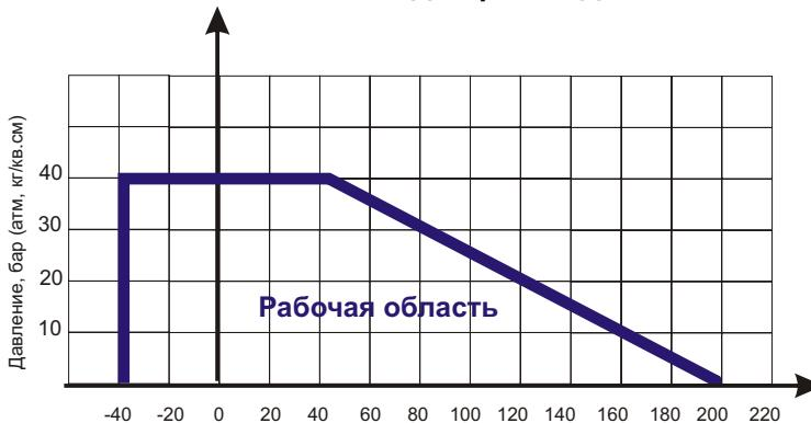
Диаграмма определяет рабочую область для шарового крана резьбового ABRA-BV-027A в координатах Давление (в барах приборного) / Температура (° C).
