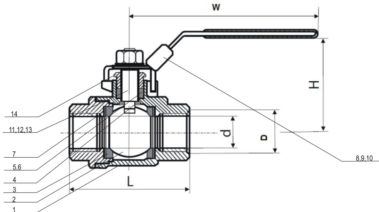
Условное графическое изображение шарового крана из нержавеющей стали на чертежах и схемах :
