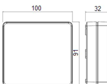
Преобразователь предназначен для настенного монтажа. Преобразователь должен быть установлен вертикально. В месте установки преобразователя должна быть свободная циркуляция воздуха без каких либо препятствий, рядом с преобразователем не должно быть нагревателей и охладителей. На преобразователь не должны попадать непосредственные потоки воздуха из системы вентиляции, солнечные лучи и пр.
