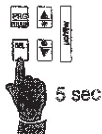
En appuyant sur SEL pendant plus de 5 secondes les principaux paramètres de contrôle de la machine appelés UTILISATEUR peuvent être visualisés (lecture des sondes) ou modifiés (températures de consignes-différentielles).
