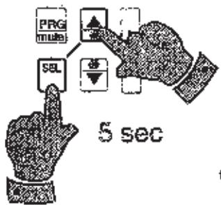
En appuyant SEL et UP pendant plus de 5 secondes, on peut habiller le dégivrage forcé (si l'état de la machine le permet).
