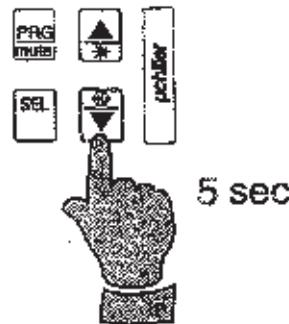
En appuyant sur DOWN pendant plus de 5 secondes on peut habiller/déshabiller la modalité de fonctionnement hiver. Il est impossible de passer directement de la procédure ETE à HIVER: si la machine est en mode ETE toute pression est inutile.
