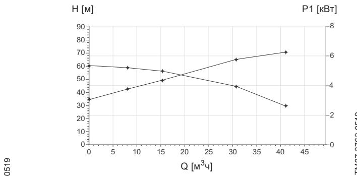
Рис. 97 Результаты измерений для испытываемого насоса
