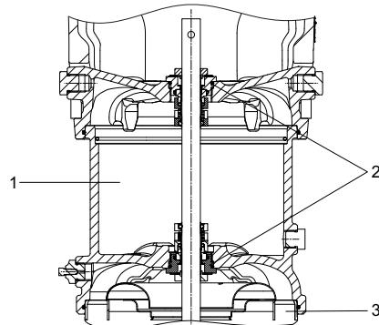
Рис. 35 Насосы CR 95, 125 и 155 с уплотнением "back-to-back"
