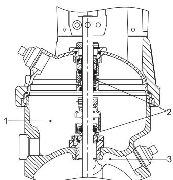
Рис. 32 Насосы CR 1s - 5 с уплотнением "back-to-back"
