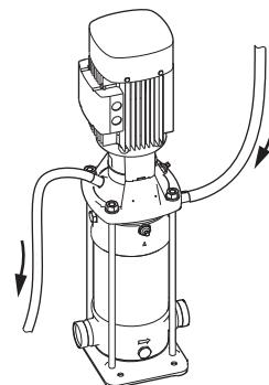
**Рис. 45** Уплотнение типа "tandem" со сливом промывочной жидкости
