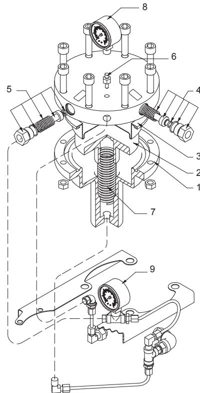
Рис. 38 Узлы гидромультиликатора давления
