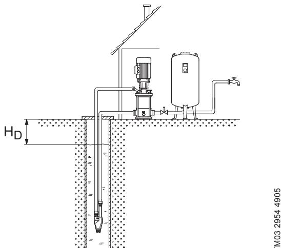
Рис. 66 Система с глубинным насосом CR(I)
