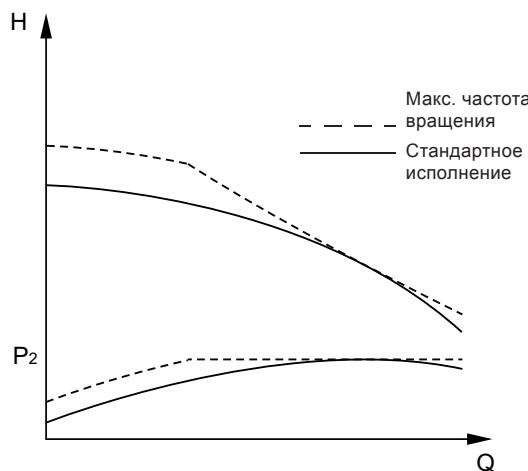
**Рис. 113** Кривые рабочих характеристик стандартного электродвигателя (60 Гц) по сравнению с кривой рабочих характеристик насоса, работающего с максимальной частотой вращения.
