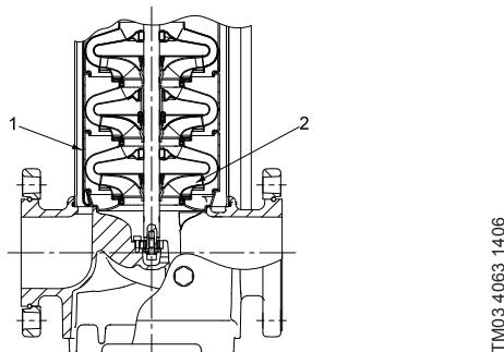
Рис. 60 Чертеж насоса CR с низким NPSH в разрезе
