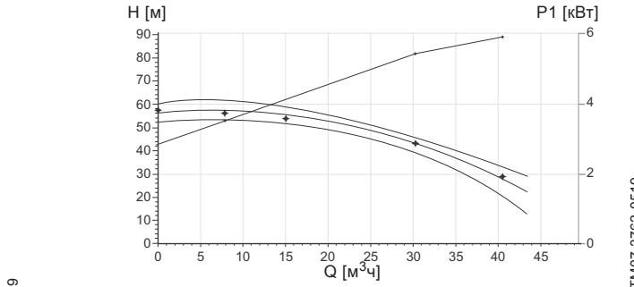
Рис. 98 Расчет значений на рис. 97 произведен для стандартной частоты вращения с целью сравнения с эталонной кривой рабочих характеристик
