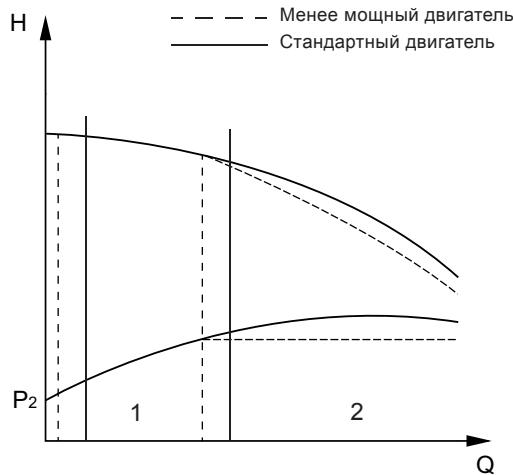
**Рис. 112** Кривые рабочих характеристик стандартного электродвигателя по сравнению с кривой рабочих характеристик насоса, оснащенного электродвигателем MGE уменьшенной мощности
