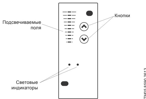
Рис. 103 Стандартная/расширенная панель управления
