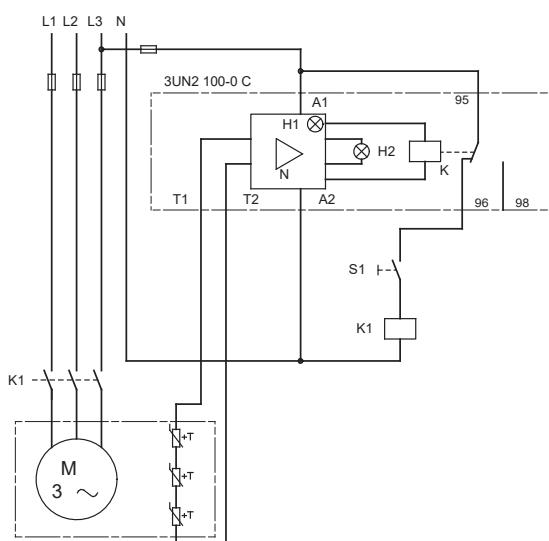
Рис. 27 Трехфазный электродвигатель с датчиками PTC
