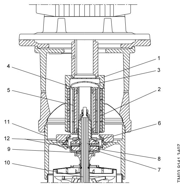
**Рис. 57** Чертеж системы MAGdrive в разрезе
