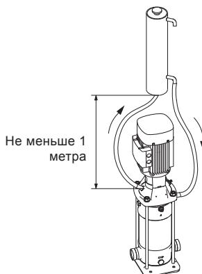
**Рис. 43** Уплотнение типа "tandem" с циркулирующей промывочной жидкостью
