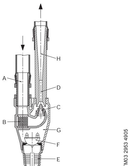
Рис. 67 Чертеж эжектора в разрезе
