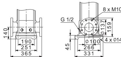
Рис. 82 Хомутное соединение для CRI, CRN 64
