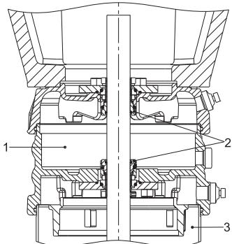
Рис. 34 Насосы CR 32, 45 и 64 с уплотнением "back-to-back"
