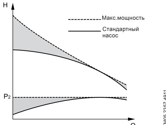
**Рис. 111** Кривые характеристик стандартного E-насоса и насоса, работающего на пределе мощности
