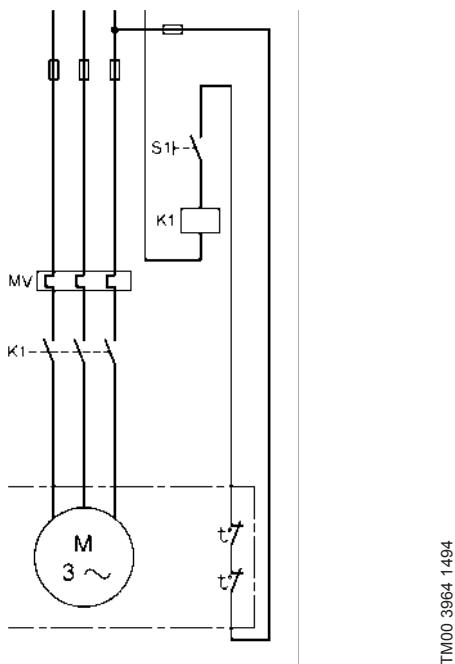
**Рис. 29** Трехфазный электродвигатель с термовыключателем
