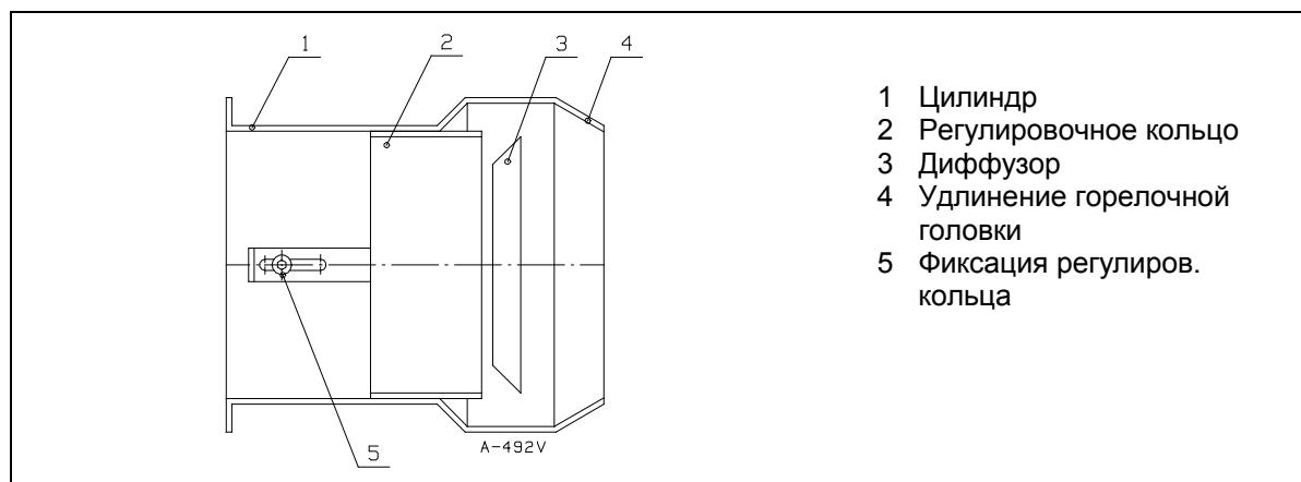
**Вним!** Если место кольца относительно диффузора меняется, также скорость и расход воздуха меняются. Проверьте результат сжигания анализом дымовых газов и подрегулируйте подачу воздуха.
