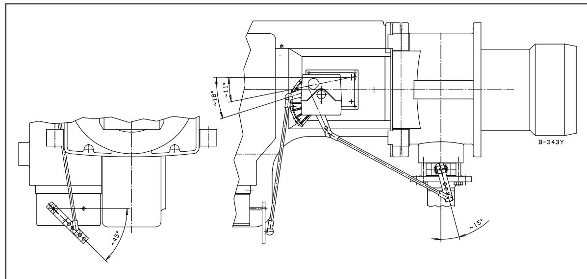
Положения рычагов на рисунке (положение сервомотора 0°) являются условными. По необходимости они могут быть изменены, напр. в зависимости от производительности горелки, типа котла, рода газа.
