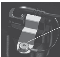
Рис. 44 Заземляющий провод датчика
