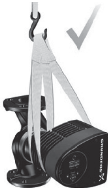
Рис. 7 Правильный способ строповки насоса
