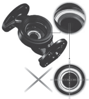
Рис. 16 Неправильно выровненная система уплотнений
