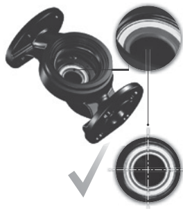
Рис. 15 Правильно выровненная система уплотнений
