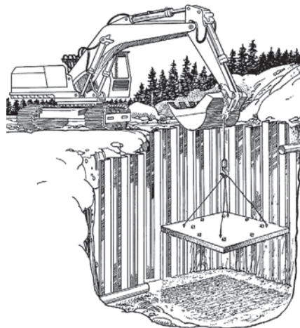
8-сүр. Фундаменттик плитаны түшүрүү
