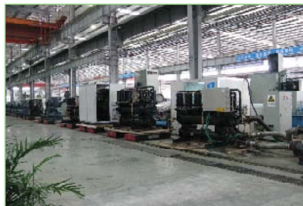
Линия испытательных стендов для чиллеров с водяным охлаждением конденсатора
