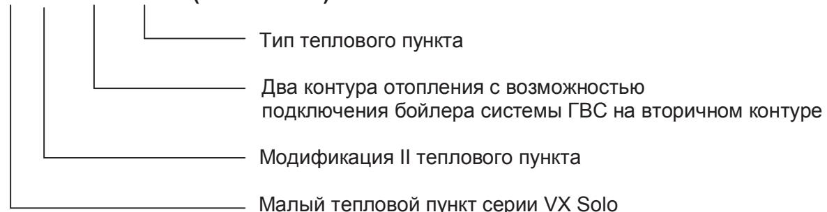
Пример условного обозначения малых тепловых пунктов модификации VX Solo HWS OP с возможностью подключения аккумуляторного бака системы ГВС на вторичном контуре:
