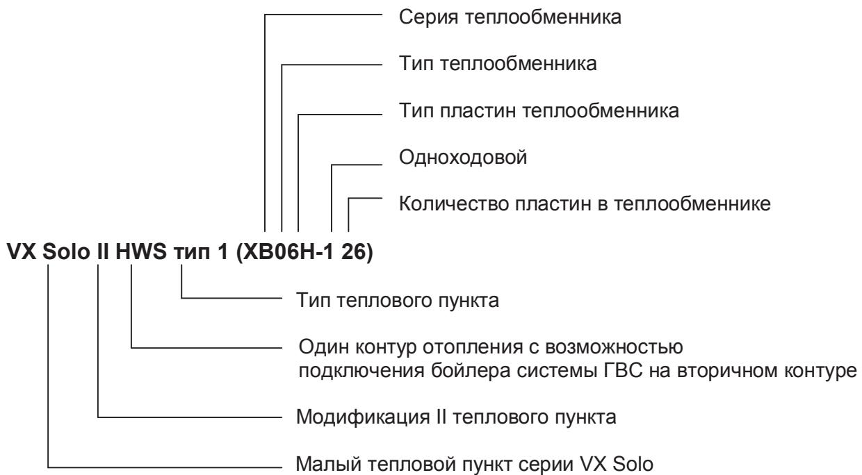
Пример условного обозначения малых тепловых пунктов модификации VX Solo II HWS, 1 НЕ с контуром отопления со смесительным узлом и возможностью подключения бойлера системы ГВС на вторичном контуре:
