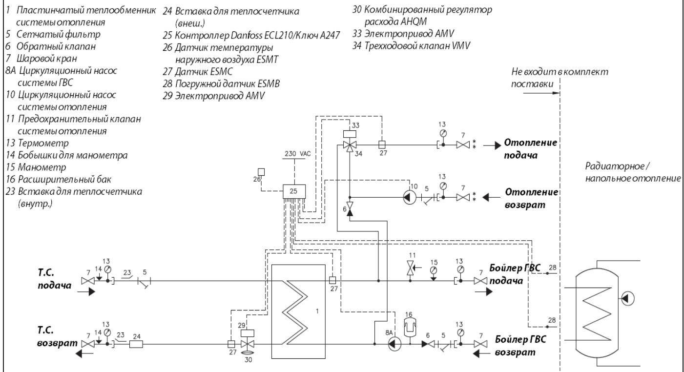
**Рис. 16. Принципиальная схема малого теплового пункта модификации VX Solo II HWS, 1 НЕ со смесительным узлом**
