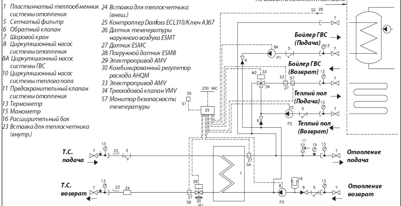
**Рис. 17. Принципиальная схема малого теплового пункта модификации VX Solo II H2WS, 2 НЕ**
