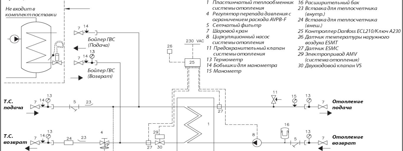
**Рис. 13. Принципиальная схема малого теплового пункта модификации VX Solo II HWP, 1 HE**
