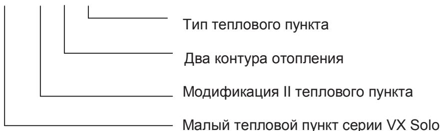
Пример условного обозначения малых тепловых пунктов модификации VX Solo II HWP, 1 НЕ с возможностью подключения бойлера системы ГВС на первичном контуре:
