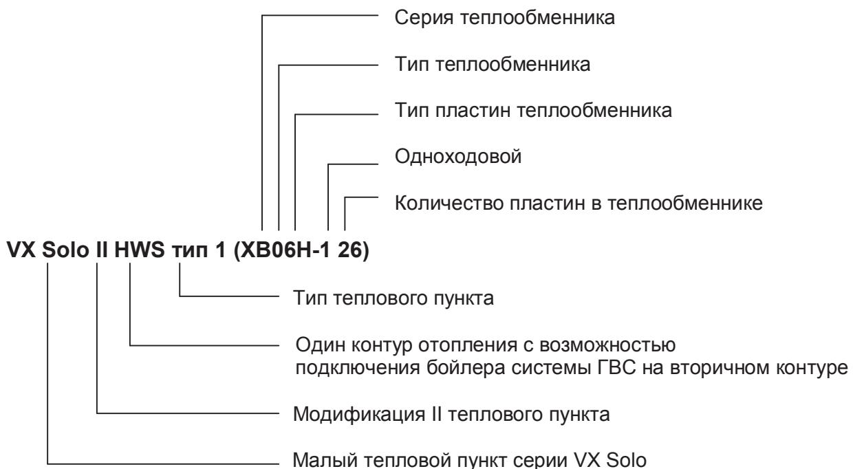
Пример условного обозначения малых тепловых пунктов модификации VX Solo II H2WS, 2 НЕ с возможностью подключения бойлера системы ГВС на вторичном контуре:
