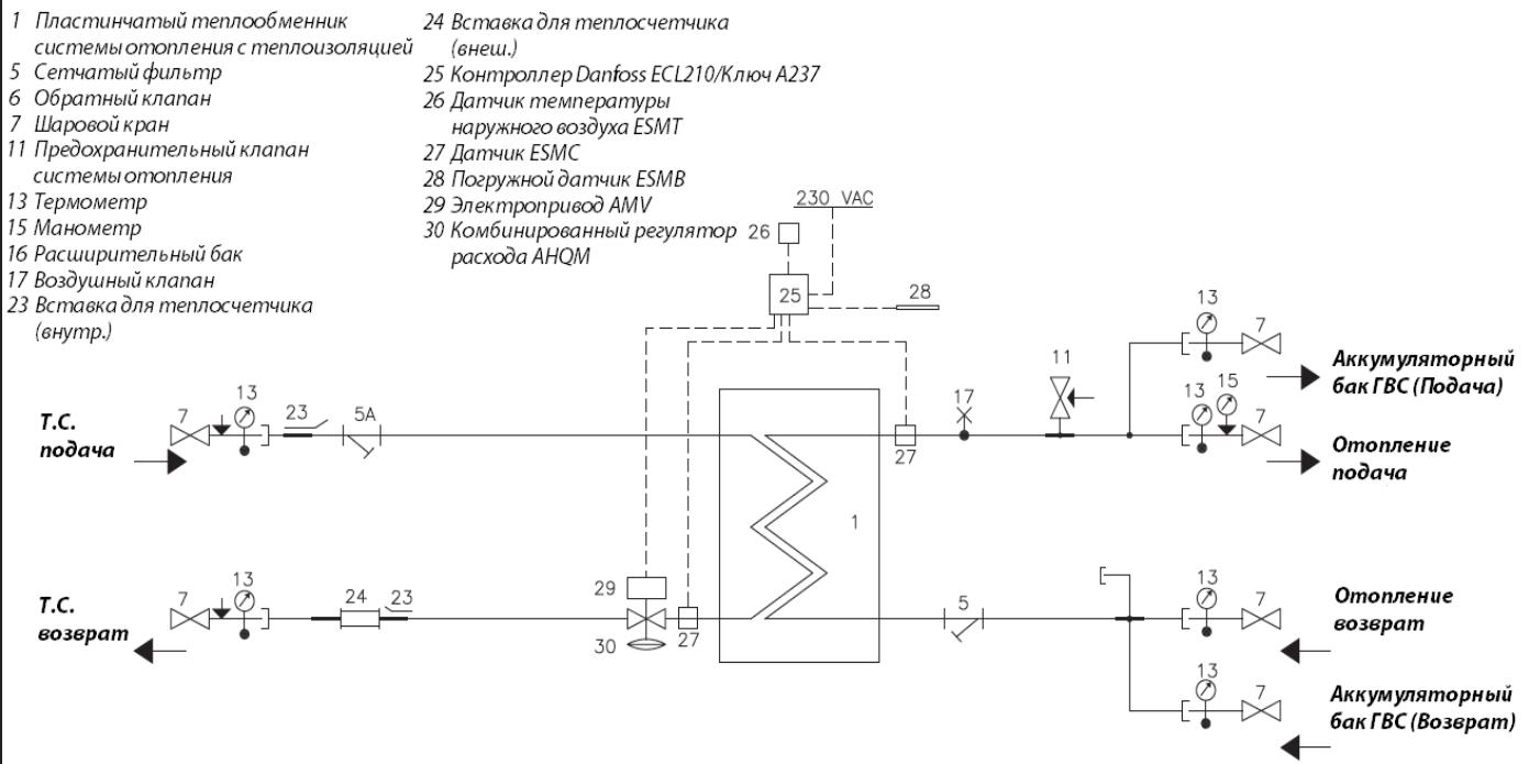
Рис. 18. Принципиальная схема малого теплового пункта модификации VX Solo HWS OP
