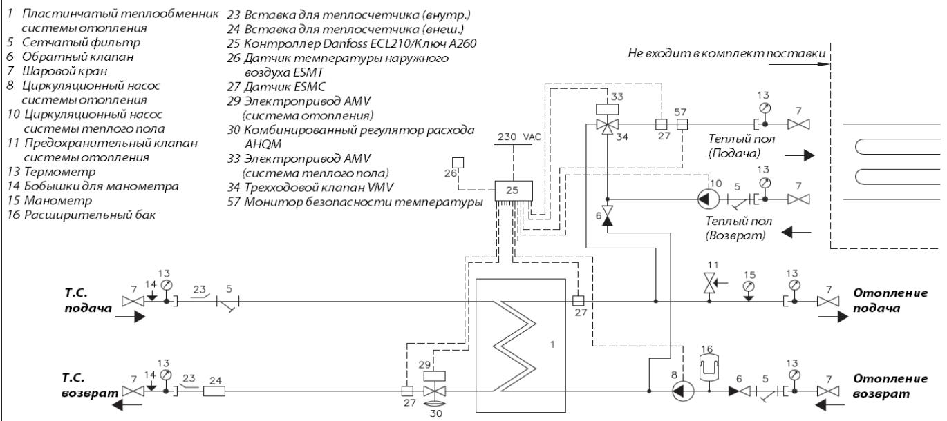
**Рис. 12. Принципиальная схема малого теплового пункта модификации VX Solo II H2, 2 HE**
