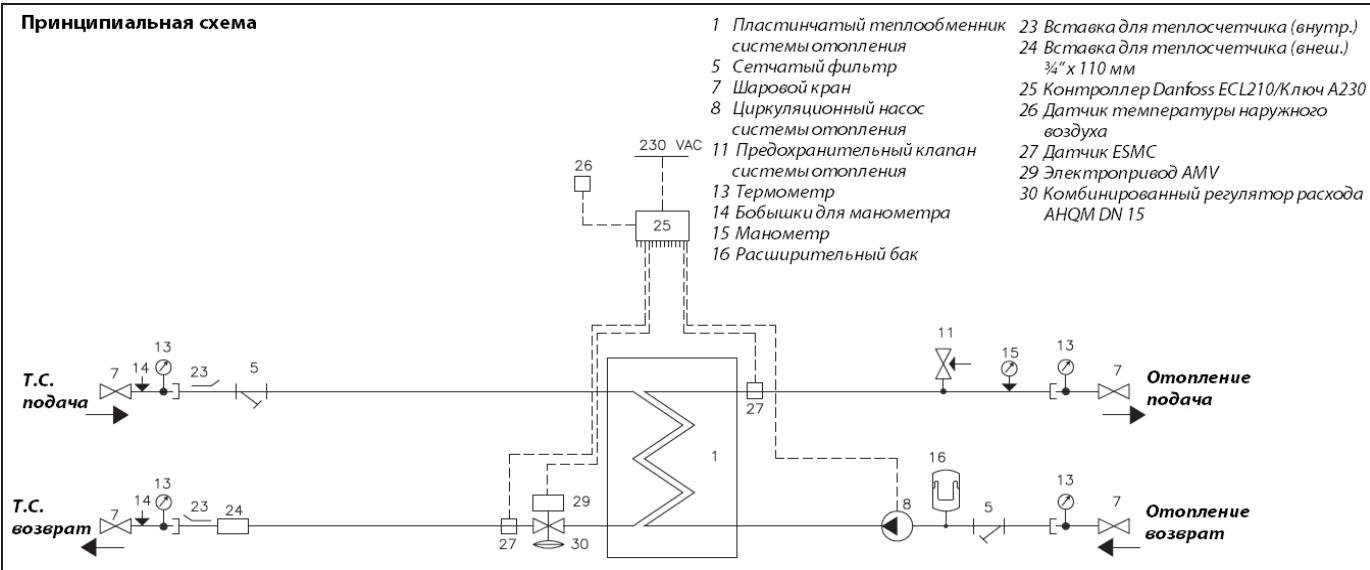
**Рис. 11. Принципиальная схема малого теплового пункта модификации VX Solo II H, 1 HE**
