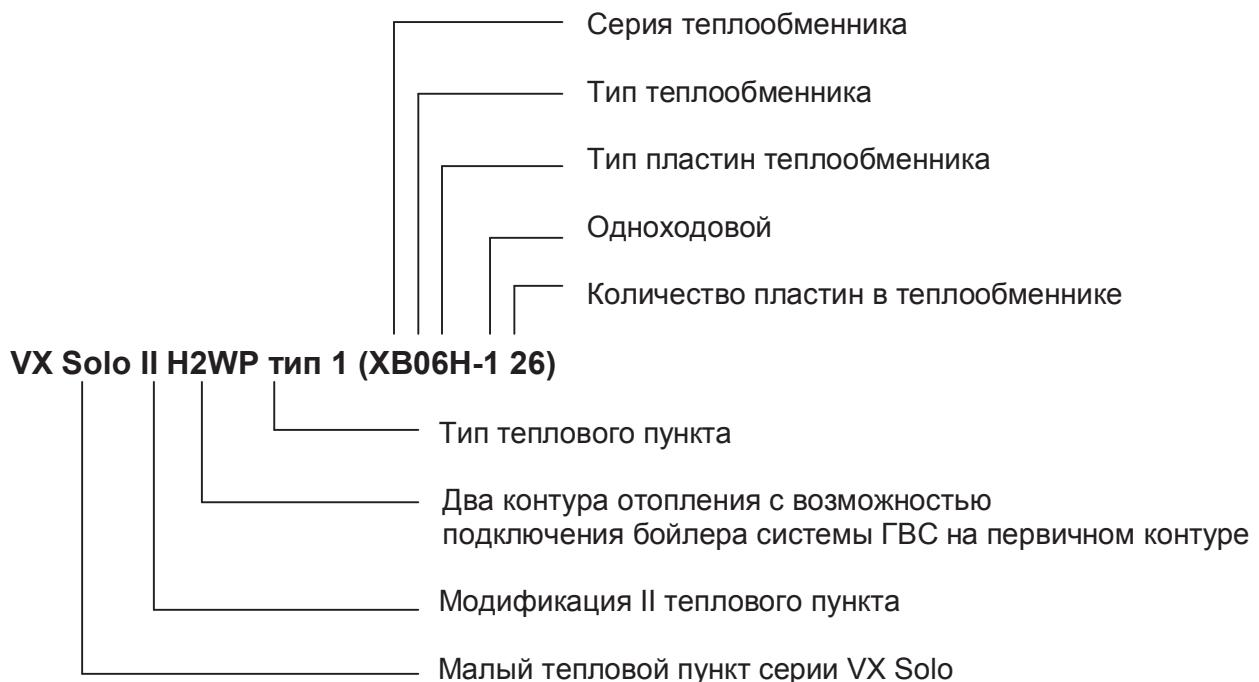
Пример условного обозначения малых тепловых пунктов модификации VX Solo II HWS, 1 НЕ с возможностью подключения бойлера системы ГВС на вторичном контуре:
