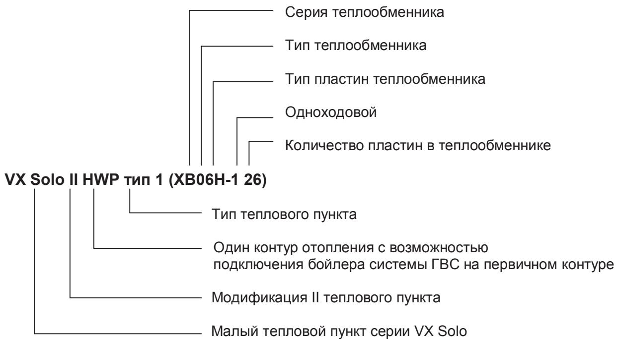
Пример условного обозначения малых тепловых пунктов модификации VX Solo II H2WP, 2 НЕ с возможностью подключения бойлера системы ГВС на первичном контуре:
