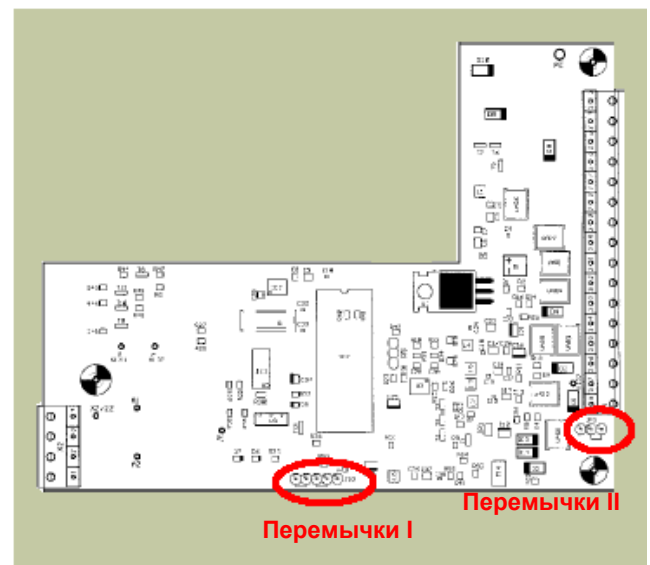
Рис. Для перестановки переключателей групп I и II снимите крышку с блока управления
