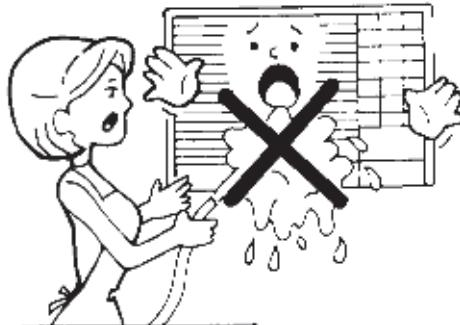
Не очищайте кондиционер **струей воды**, и не допускайте попадания воды на его поверхность. Вода повредит электрические компоненты прибора и изоляцию проводов - это опасно!
