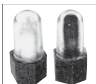
Индикатор сигнального анода. Слева: не отработанный – белый Правый отработанный – красный
