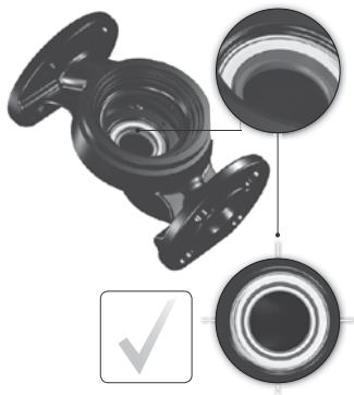
Նկար 16 Խցվածքների ճիշտ հավասարեցրած համակարգ
