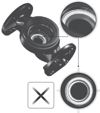
17-сүр. Туура эмес тегизделген тыгыздоо тутуму
