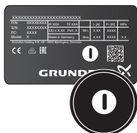
Рис. 34 Обозначение главной головной части на фирменной табличке (заводская установка)
