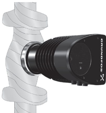
Рис. 19 Изоляция корпуса насоса и трубопровода
