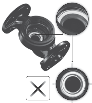
Рис. 17 Неправильно выровненная система уплотнений
